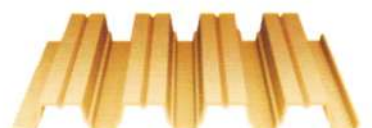
ПРОФНАСТИЛ С16 Монтажная ширина: 1 000 мм Общая ширина: 1 050 мм Толщина проката: 0,30 – 0,50 мм
